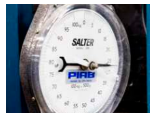
Zugprüfinstrument für Wohnwagen.
