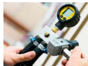
Das Gassystem wird Drucktests unterzogen.
