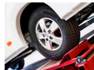
Der Beständigkeitstest wird auf einem Rüttelstand durchgeführt und entspricht einer normalen Fahrleistung von 100.000 km.
