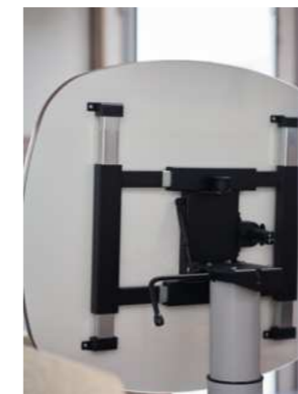
Der Tisch ist nach vorne umklappbar (im Van ausbaubar), sodass zwischen Fahrersitz und den Passagieren auf der Dinette mehr Platz entsteht. Das sorgt für erhöhte Sicherheit unterwegs.
