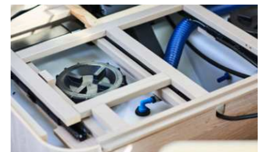
Im Inneren der Dinette befindet sich ein verstärkter Metallrahmen, der verhindert, dass die Sitzgruppe bei einem Unfall nachgibt. Der Metallrahmen hält auch den Wassertank an seinem Platz und die gesamte Sitzgruppe ist mit dem fest im Boden verankerten Rahmen des Wassertanks verbunden.
