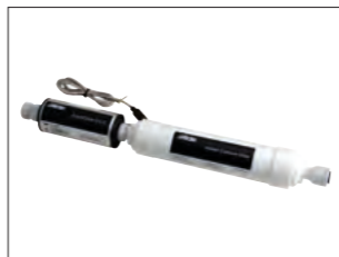
"Wasserreinigung" – Alde AquaClear UV-C (für Heizkessel Alde Compact 3030). Wirkungsvolle Wasserreinigung schützt die Gesundheit des Benutzers auf umweltfreundliche Weise. Unerwünschte Keime werden abgetötet, Bekämpfungsmittel und Chemikalien werden ausgesondert. Das Wasser wird durch das UVC-Licht von Leuchtdioden desinfiziert. Danach durchläuft es einen Kohlefilter, der für ein geruchs- und geschmacksneutrales Wasser ohne Missfärbung sorgt.
