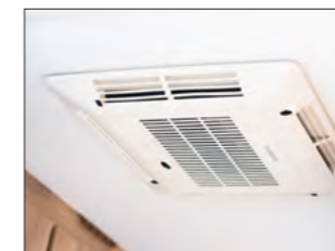
Klimaanlage im Wohnbereich Fresh Jet FJ2200
