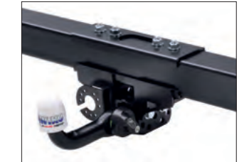
Anhängerkupplung (zulässige Anhängelast max. 2.000 kg gebremst)
