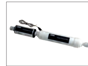
"Wasserreinigung" – Alde AquaClear UV-C (für Heizkessel Alde Compact 3030). Wirkungsvolle Wasserreinigung schützt die Gesundheit des Benutzers auf umweltfreundliche Weise. Unerwünschte Keime werden abgetötet, Pestizide und Chemikalien werden ausgesondert. Das Wasser wird durch das UVC-Licht von Leuchtdioden desinfiziert. Danach durchläuft es einen Kohlefilter, der für ein geruchs- und geschmacksneutrales Wasser ohne Eintrübungen sorgt.
